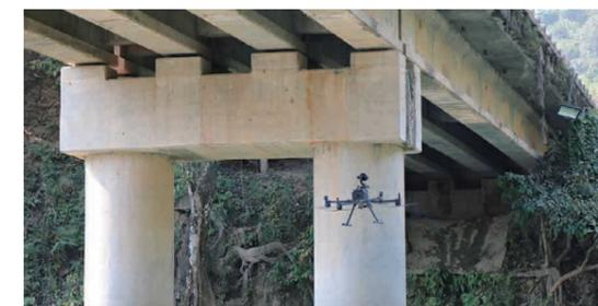
上：現地のオペレーターが操作するドローンと画像診断技術を組み合わせたパイロット点検の様子。右：検知されたひび割れが色分けされる仕組み。
