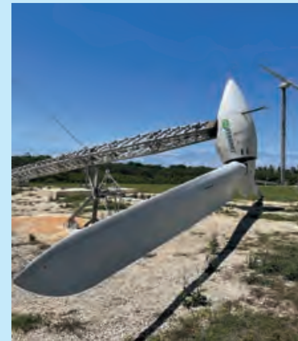
サイクロンが頻発するトンガに日本の無償資金協力で導入された風車。可倒式であり、サイクロンなどの強風時には地面に倒れて破損を防ぐことができる。台風の襲来が多い沖縄県の企業の技術が採用され、トンガにおける再生可能エネルギーの推進に貢献している。
